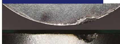
Grenz- oder Kerbverschleiß
