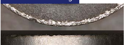
Verschleiß an einem Rotationswerkzeug
